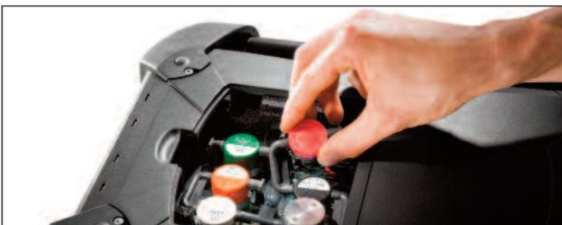
Plug & play: fácil reemplazo de los sensores
